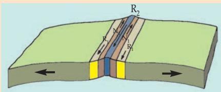
Într-un moment ulterior, noua materie din rift (N<sub>2</sub>) are lateral materie solidificată anterior (R<sub>1</sub>, N<sub>1</sub>, R<sub>2</sub>), cu polarități magnetice diferite și o vîrstă care crește de la rift spre exterior (R<sub>1</sub> > N<sub>1</sub> > R<sub>2</sub> > N<sub>2</sub>).
